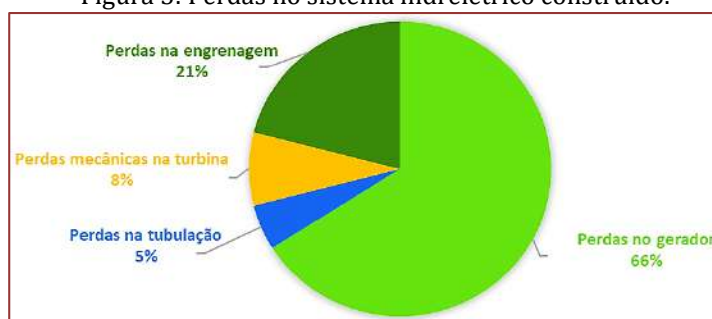
Figura 5: Perdas no sistema hidrelétrico construído.
