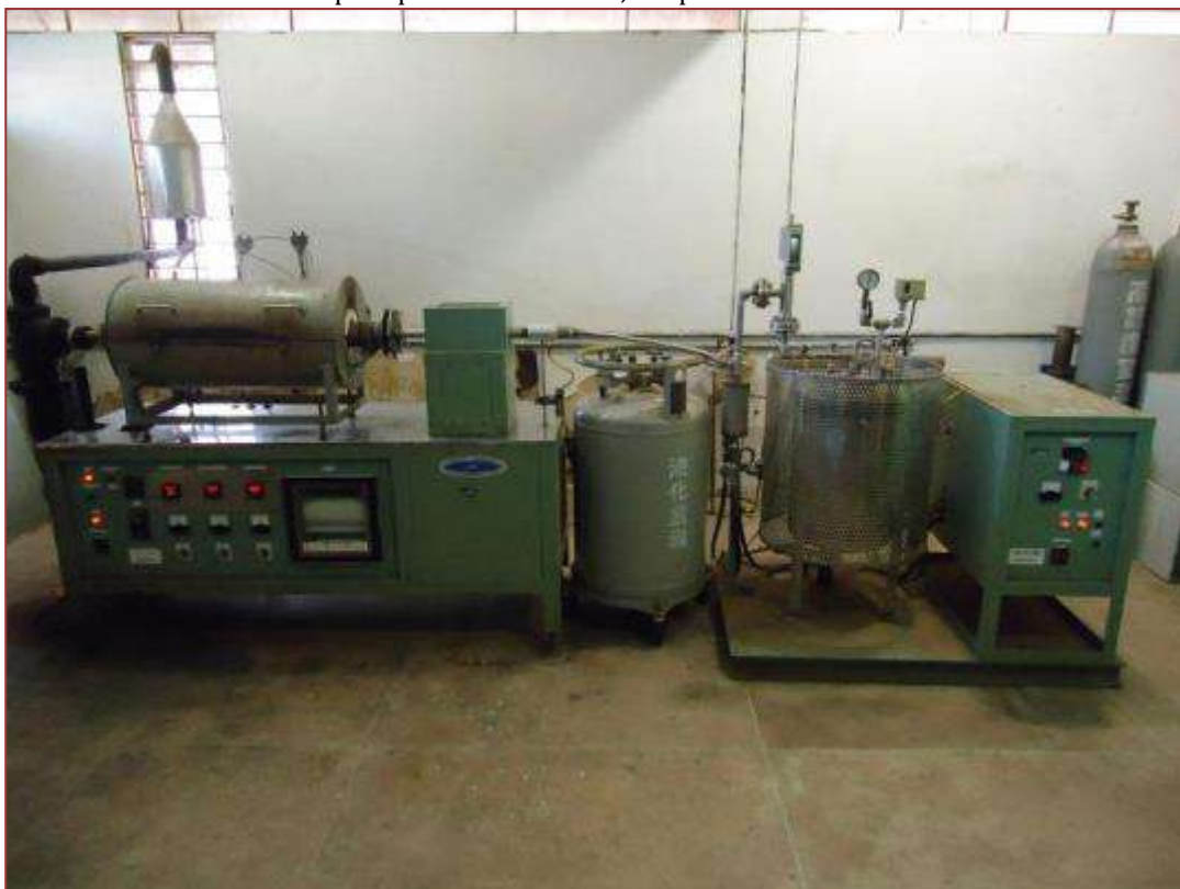
Figura 2 - Forno-reator tubular de leito fixo com rampa de aquecimento digital em atmosfera de N 2 para pirólise da CHINO, adaptado à caldeira.
